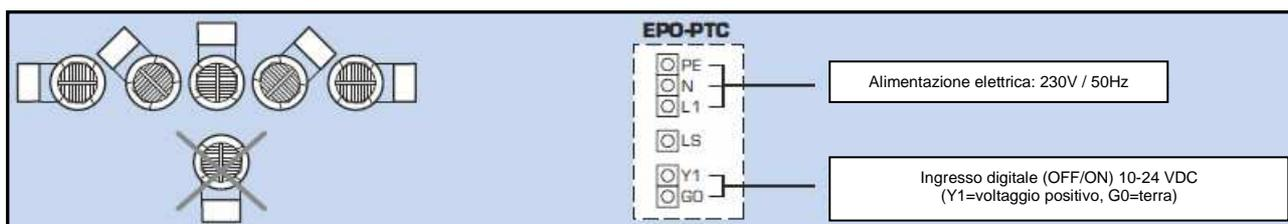
Le batterie elettriche EPO-PTC devono essere utilizzate solamente con unità Duplex Easy o Duplex EC(V)4; il sistema di controllo delle unità di ventilazione garantisce il funzionamento ottimale delle batterie elettriche.
